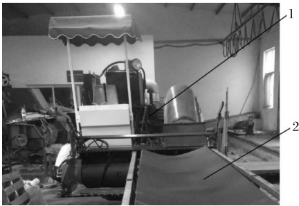
1.联合收获机及相关测试装置 Experiment device; 2.输送带 Conveyer belt.
