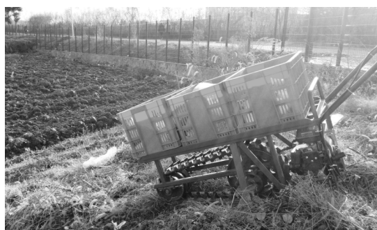
图13 运输车纵向下坡行驶测试图
