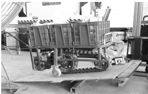
图 11 运输车静态稳定性现场测试图
