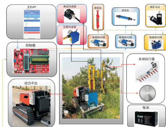
图1 果树修剪机控制系统硬件结构图
